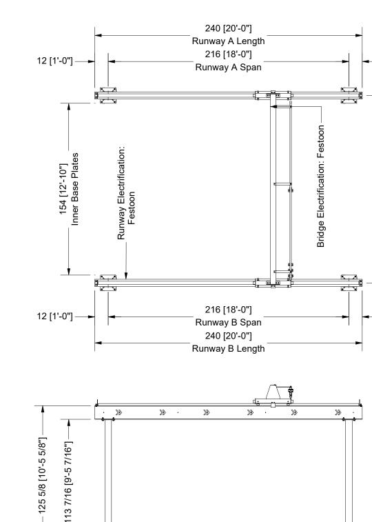
VOLTAGE : 208-240v Single Phase **416 SERIES TRACK SERIES:** SYSTEM QTY: **BRIDGE QTY (PER SYSTEM):** 1 **RUNWAY CAPACITY: 2.000 TON BRIDGE CAPACITY**: 2.000 TON **HOIST CAPACITY:** 2.000 TON **HOIST QTY (PER BRIDGE):** 1 **HOIST BRAND:** Starke STK HOIST MODEL NO.: STK2026-20 TROLLEY MODEL: SPT 400
